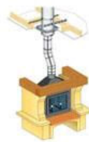
Свързване към метален изолиран комин на Poujoulat
