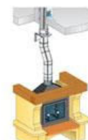
Свързване към съществуващ корав или гъвкав едностенен комин, разположен в зидана шахта (комин)
